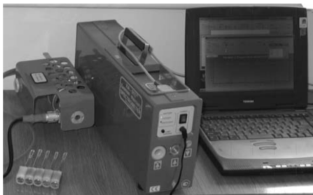
Rys. 2. Spektrometr do oznaczania zawartości rtęci Lumex RA-915+ z przystawką RP-91C
