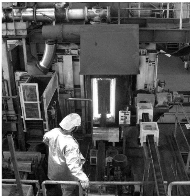
Rys. 3. Operacja wypychania koksu – widok ze strony maszynowej na piec z ruchomą ścianą 400 kg w CPM Fig. 3. Coke cake pushing operation – the view from the pusher side on the 400 kg movable wall oven in CPM
