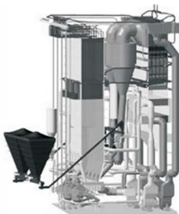
Rys. 3. Kocioł fluidalny OFz-450A firmy Rafako SA, Elektrociepłownia Żerań ( http://www.rafako.com.pl )
